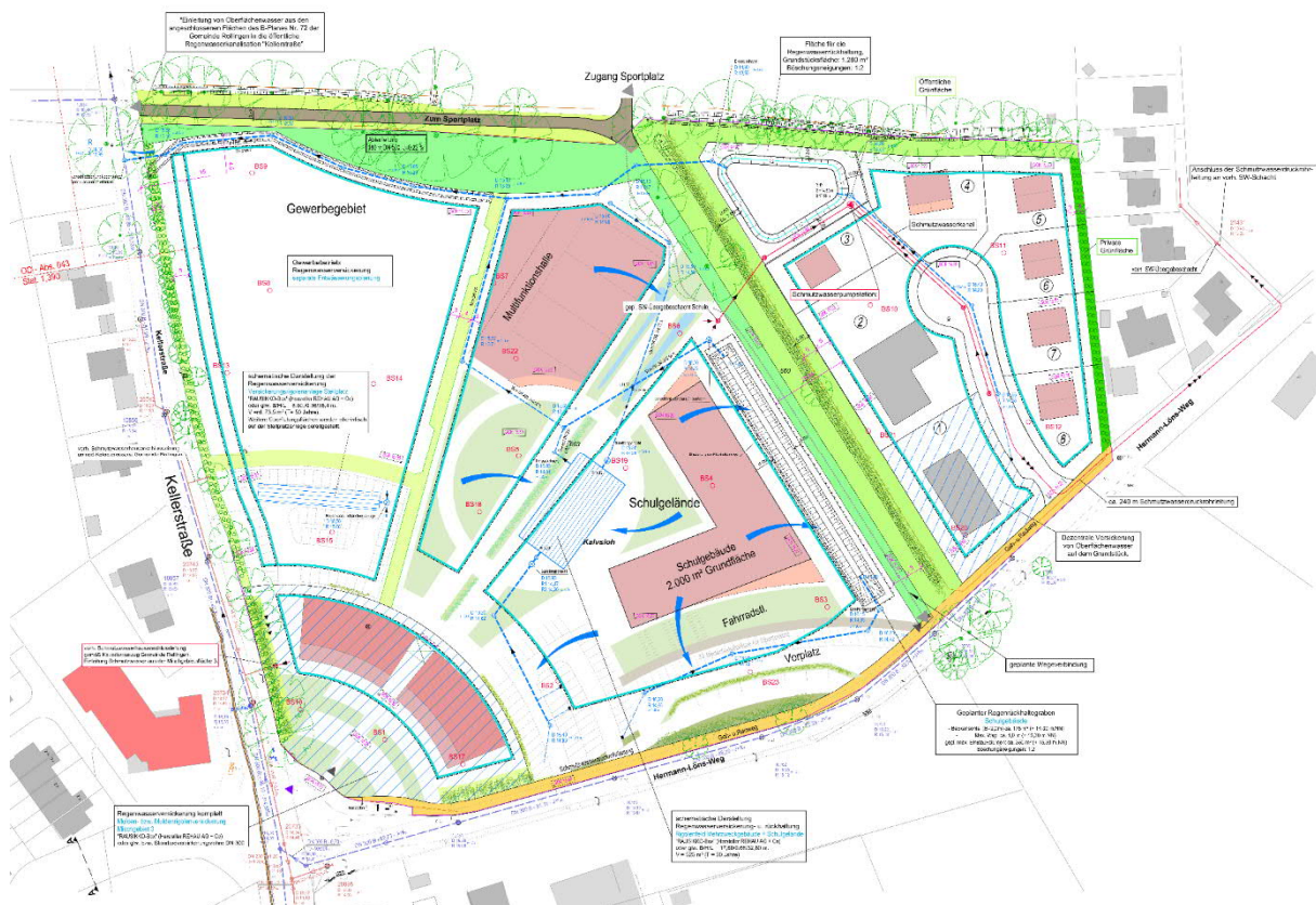
Abbildung 12 - Überlegung zur Regenentwässerung
