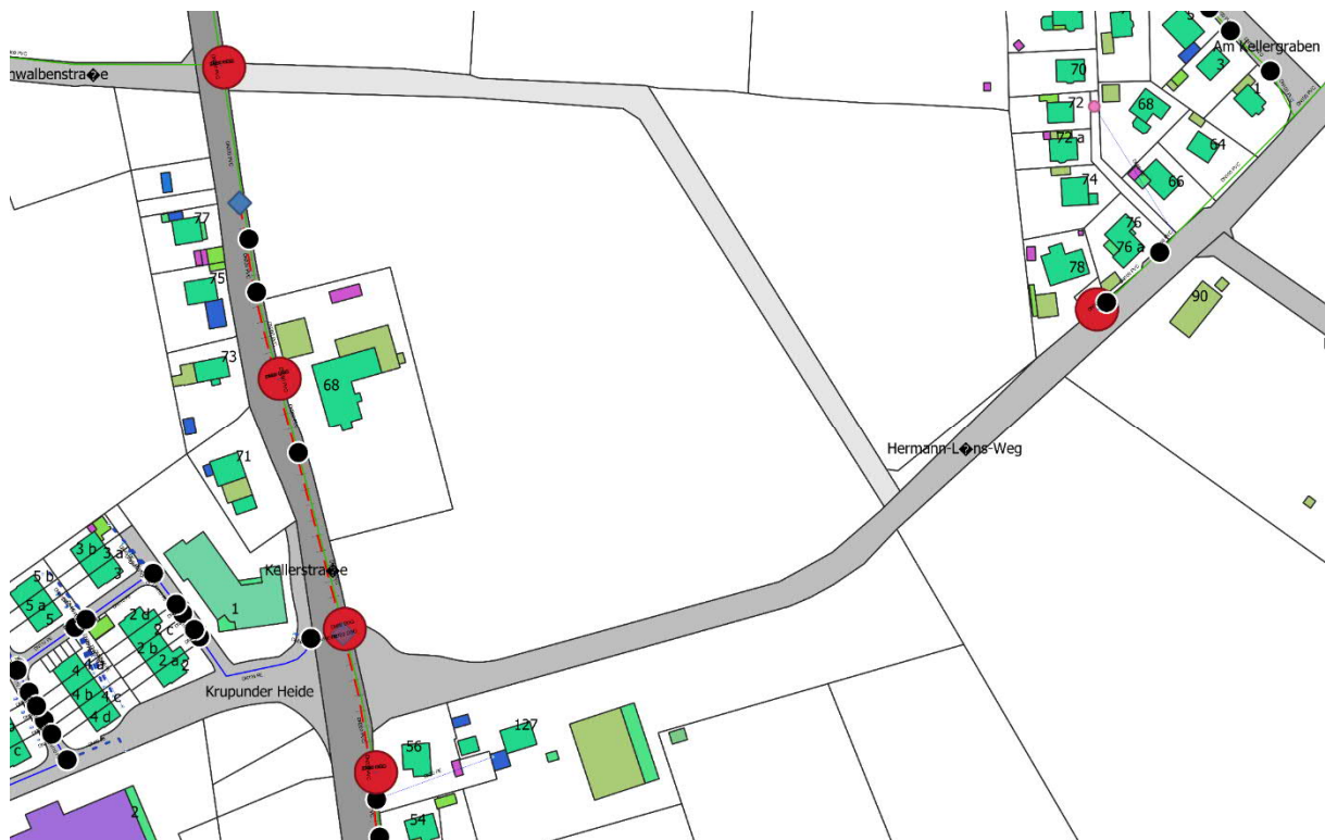
Abbildung 13 - Lageplan der Hydranten (rot)
