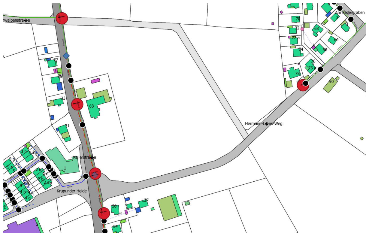
Abbildung 19 - Lageplan der Hydranten (rot)
