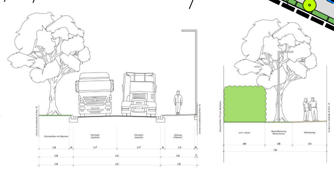
Systemschnitt „innere Gewerbegebieterschließung“ Wegeverbindung zum Gewerbegebiet
